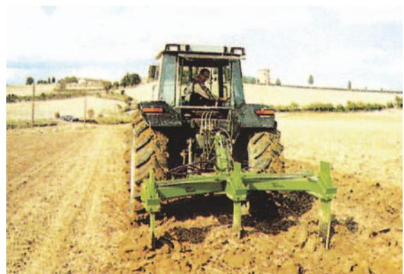
Fig. 4 - Ripuntatore-ripper a tre ancore portato da un trattore gommato (60-75 kW) (da: Buresti E. e Mori P., 2003).
